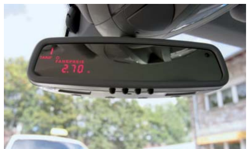
Vorrüstung im Taxipaket für das Taxameter, hier als optionales Spiegeltaxameter (u.)
