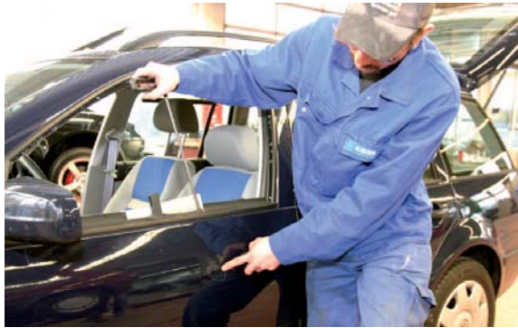
Spot-Repair für kleinere Lackschäden und Kratzer erspart den großflächigen Teiletausch (großes Bild)
