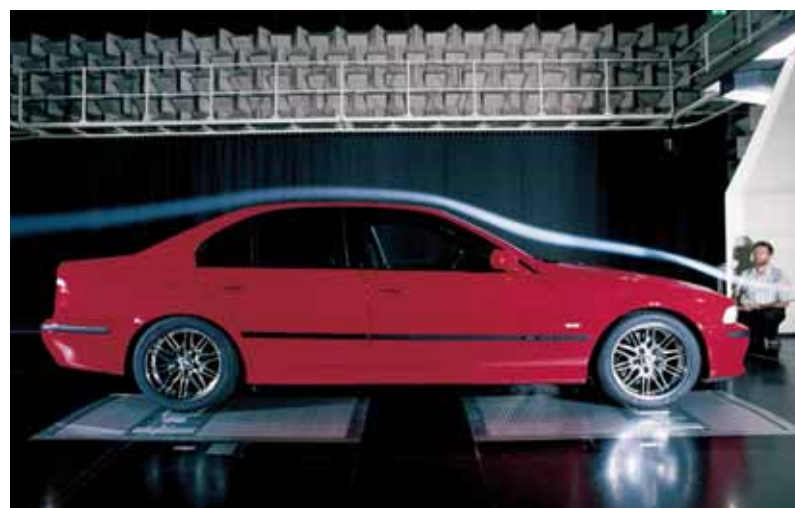
Der Cw-Wert kann sowohl experimentell, als auch rechnerisch ermittelt werden
