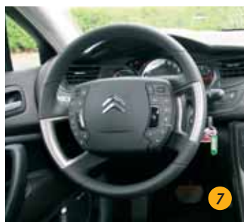
7. Lenkrad mit feststehender Nabe in zweiter Generation
