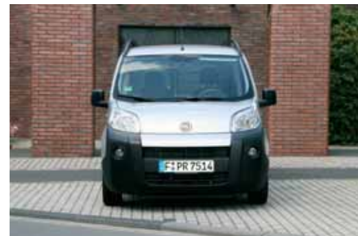
Die schwarzen Schutzleisten vorne und hinten geben dem Fiorino ein robustes Erscheinungsbild, zudem absorbieren sie kleinere Rempler (o.)
