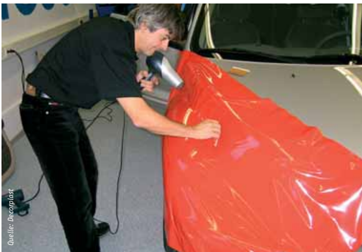
Durch Erhitzen lässt sich die Folie in Form bringen (o.)
