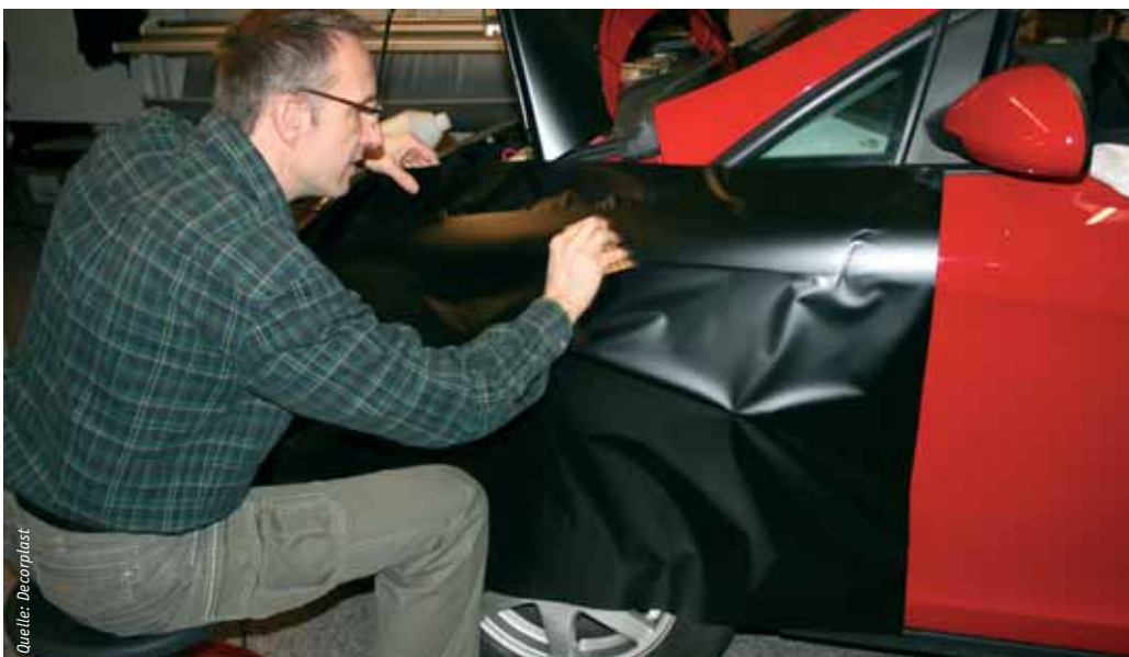
Durch Erhitzen lässt sich die Folie in Form bringen (o.)
