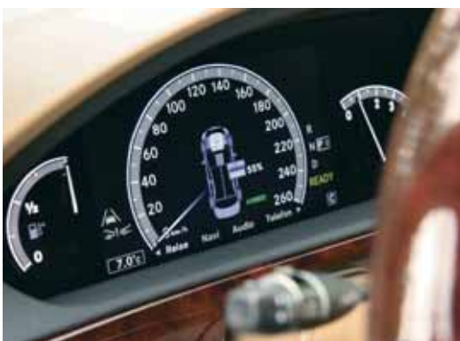
Das mittlere Segment des Kombiinstrumentes wird voll-elektronisch eingeblendet
