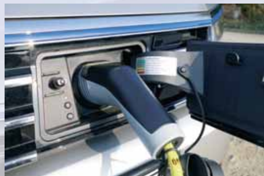
Die Batterie des Passat GTE kann einfach an der Haushaltssteckdose aufgeladen werden (li.)
